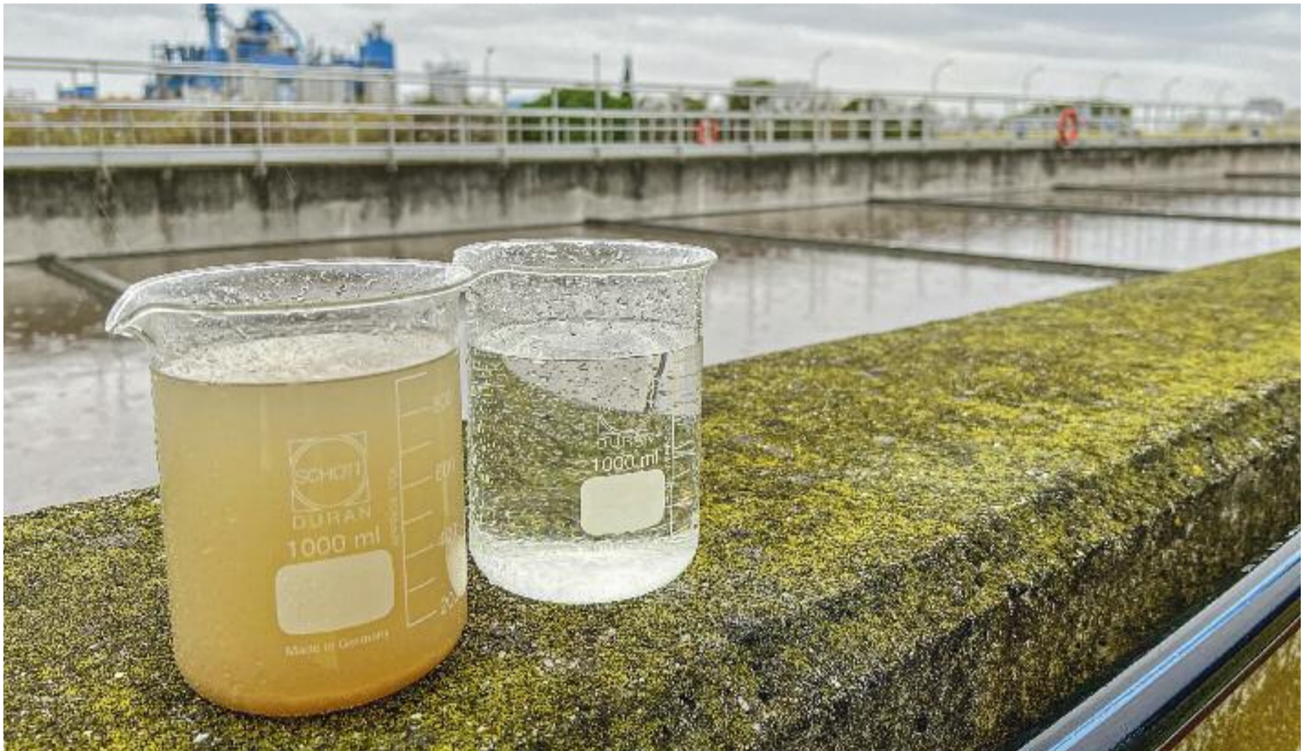
Mostra de l'aigua residual que arriba a la depuradora de Mataró i de com queda després de la regeneració. Jordi Pujolar / ACN
